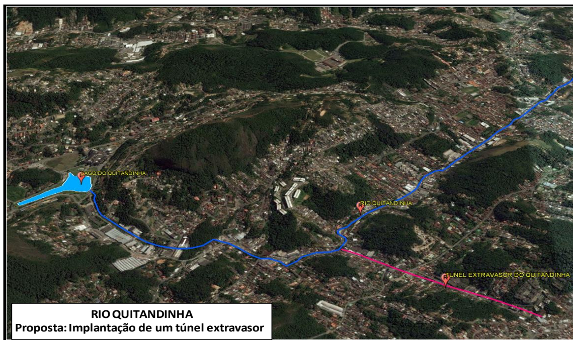
Figura 3-2 - Arranjo Geral da Solução da Implantação de um Extravasor no Rio Quitandinha
