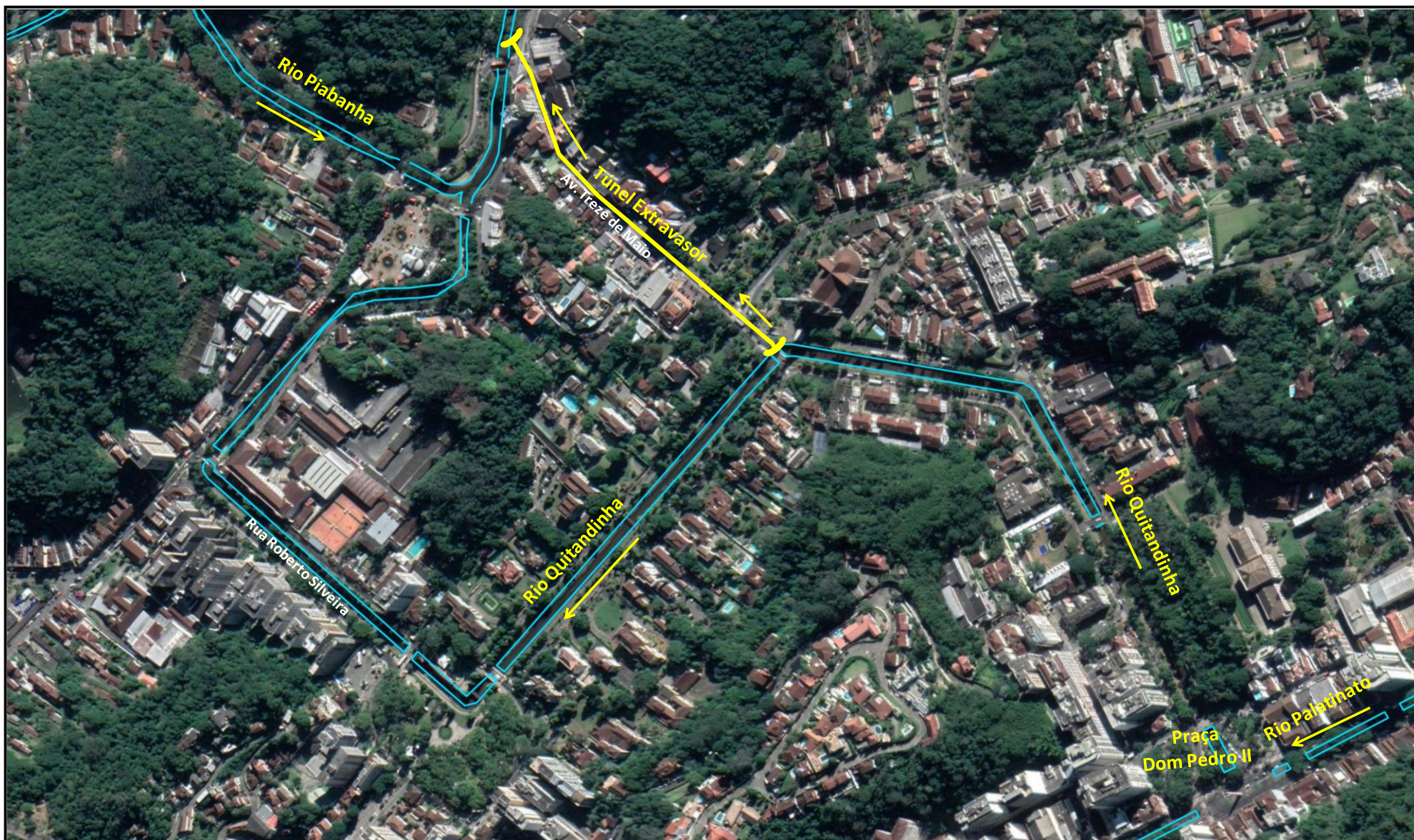
Figura 3-8 - Arranjo Geral do Túnel Extravasor Projetado pela Rua Treze de Maio
